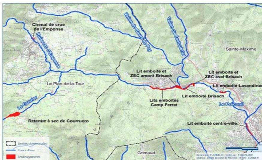
Figure 11 : Localisation des aménagements sur le bassin du Préconil pour le présent PAPI
